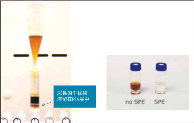
图3. GC-MS分析中利用Sep-Pak PSA/carbon小柱对QuEChERS茶叶萃取液进行净化。左图所示为样品流经小柱的净化过程，右图样品瓶为两种净化结果。
