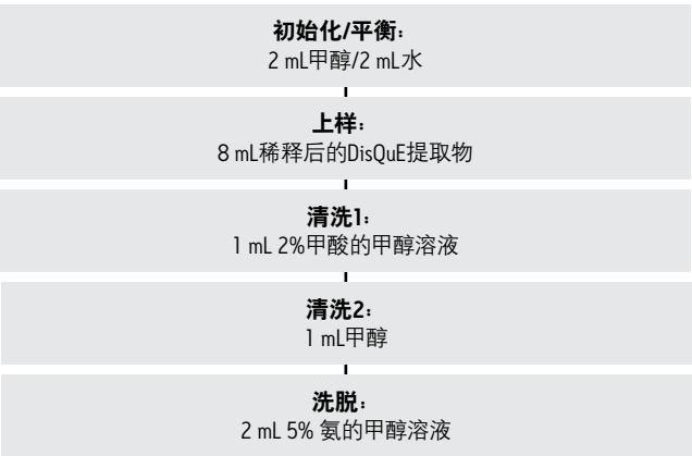
图2. 本研究中方案采用3 cc规格的Oasis MCX SPE小柱。
