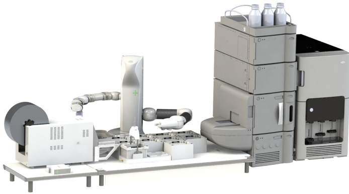
图1.带密封和过滤功能的Andrew+移液机器人与BioAccord LC-MS系统通过ACQUITY™ Automation Portal样品板装置连接的系统概览。还支持其他Andrew+组件，包括Andrew+ BenchHub、Andrew+活动旋转系统(ARS)和Plate Sealer+。
