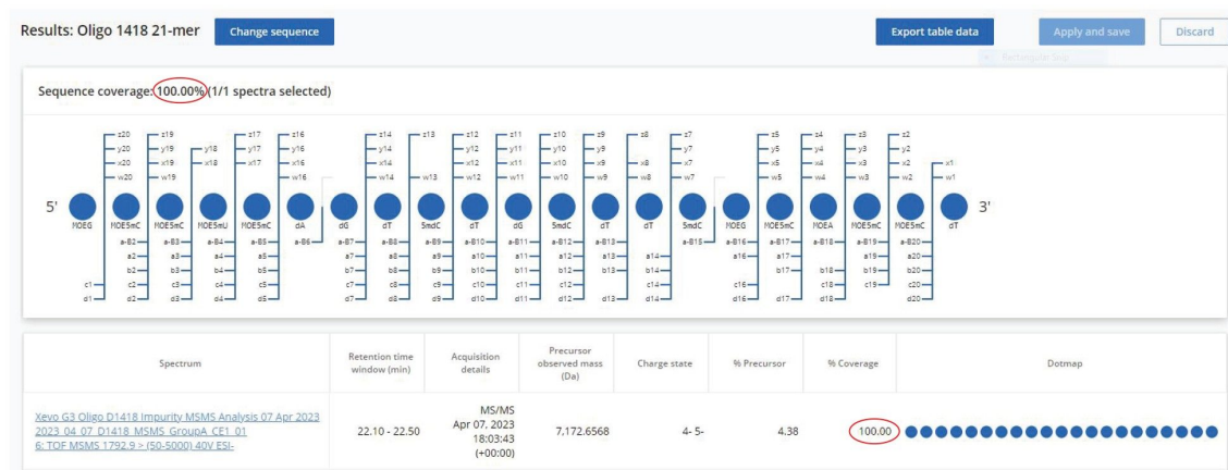
图9.MS/MS碎裂21 mer siRNA寡核苷酸的 [M-4H]^{-4} 母离子( m/z=1792.14 )获得了100%序列覆盖率。在Xevo G3 QToF质谱仪的碰撞室内使用最佳固定碰撞能量(40 V)对母离子进行碎裂。
