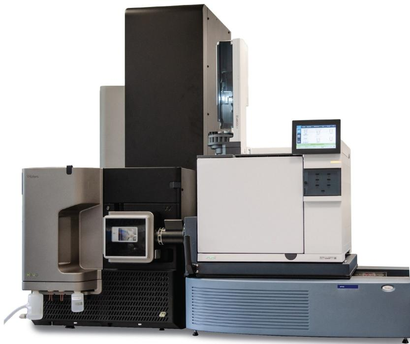
図 1. APGC および Xevo G3 QToF 質量分析計に接続された GC。
