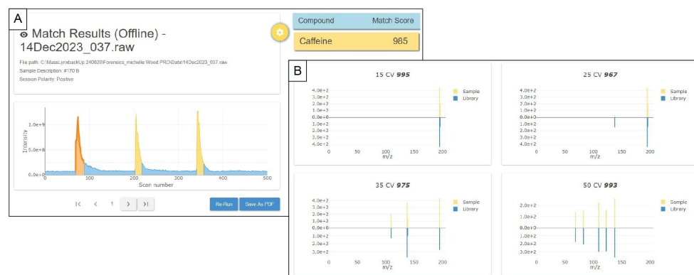
図 3.押収サンプルの LiveID 分析。パネル A に、サンプルの「浸漬と検出」の 3 回繰り返しを示しており、最初の繰り返しで得られたマッチスコアは 985（最大 1,000）であることがわかります。パネル B にこのスペクトルマッチの詳細を示します。この同定プロセスでは、4 種類すべてのコーン電圧が加重平均（最も低いコーン電圧に最も大きく重み付けする）を用いて使用されています。
