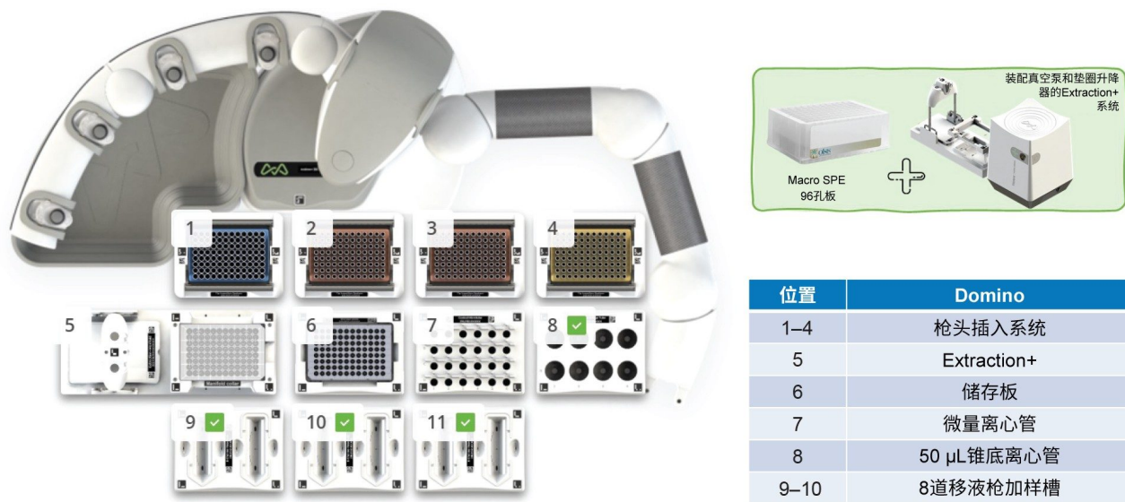
图3.Andrew+移液机器人及Extraction+的工作台布局
