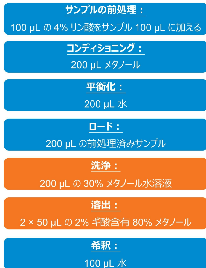
図 1. ラット血漿からのシタグリプチンおよびパルボシクリブの抽出に使用した最終的な SPE プロトコル
