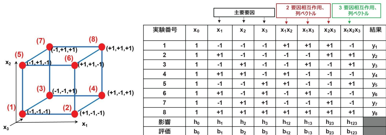
図 1. 2^3 完全要因計画（左）および関連する計画マトリックス（右）の概略図。x 1 ～ x 3 は選択された要因であり、立方体の頂点にある赤色の点（1 ～ 8）は条件、および 8 つの実験の対応する要因のレベル（+1 または -1）を示します。y 1 ～ y 8 は実験で測定されたレスポンス、b 0 ～ b 123 は算出されたモデルパラメーターです。
