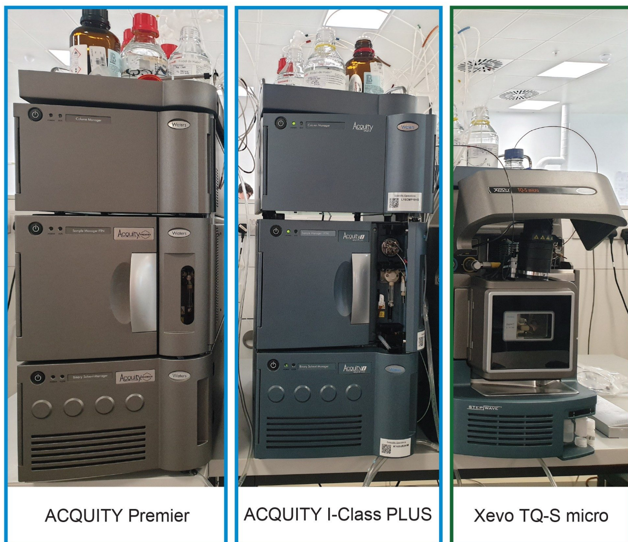
図 1. この研究で使用した構成（左から右へ：ACQUITY Premier、ACQUITY I-Class Plus、Xevo TQ-S micro）
