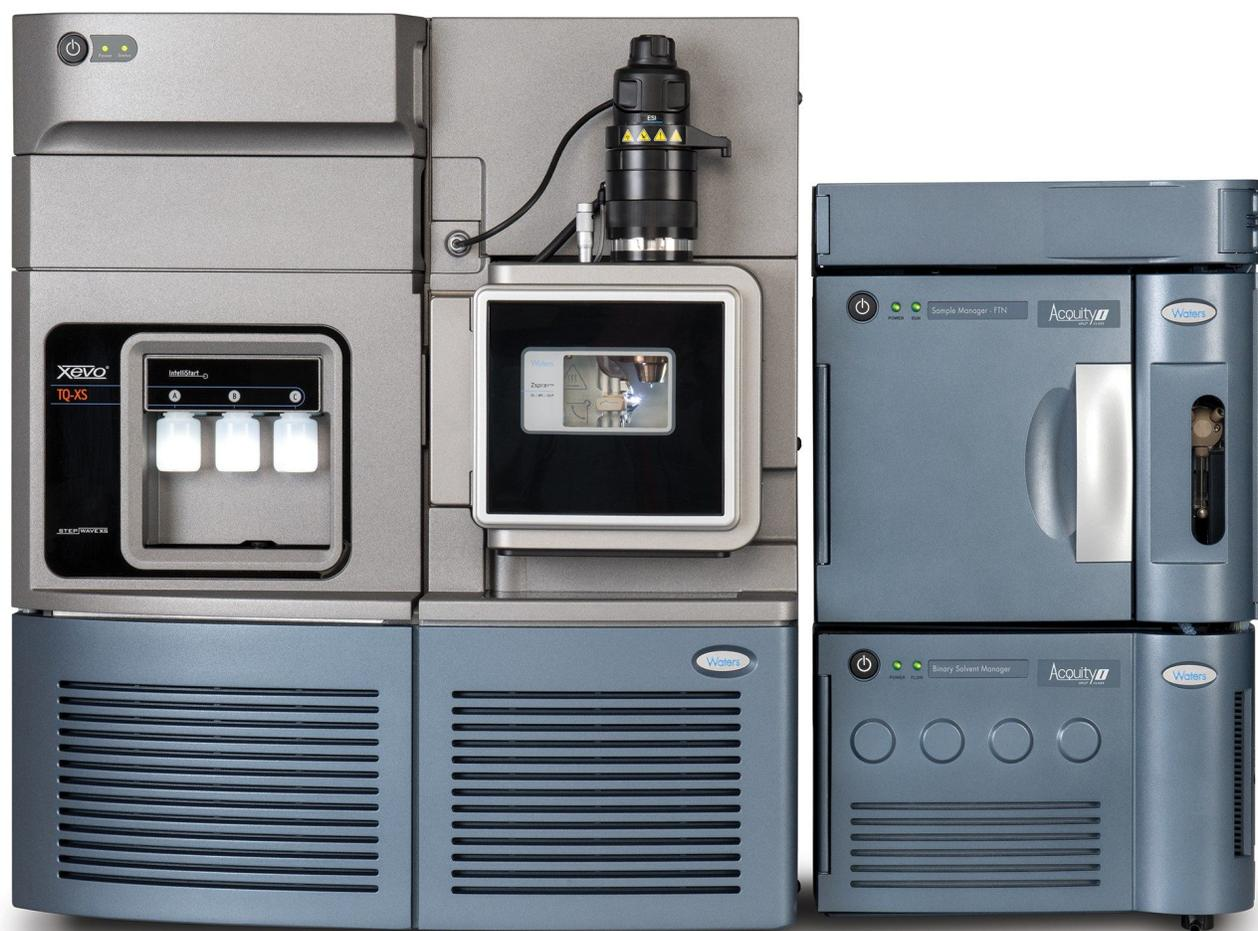
图1. Waters ACQUITY UPLC I-Class和Xevo TQ-XS质谱仪。
