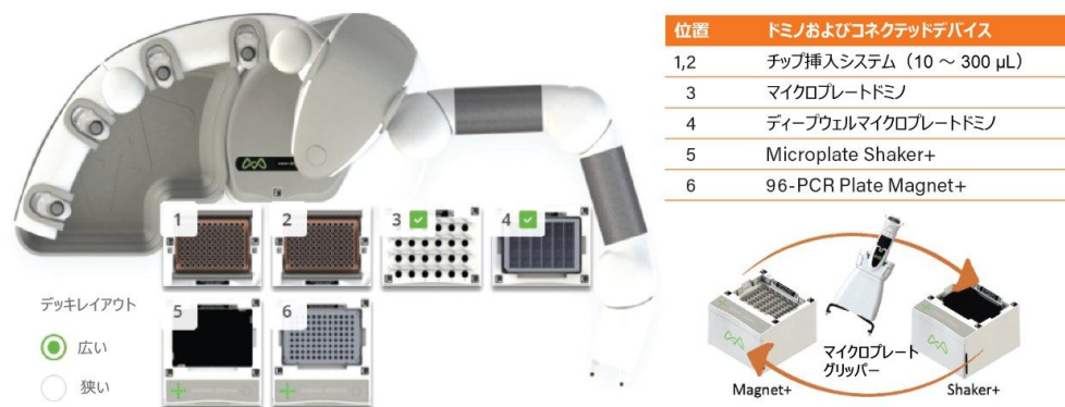
図 4. 迅速自動化抗体精製 8 サンプルプロトコル用の Andrew+ ドミノおよびコネクテッドデバイスの構成。完全自動プロトコルでは、Andrew+ に 2 つのコネクテッドデバイス（Magnet+ および Shaker+）とマイクロプレートグリッパーまたはマイクロプレートグラバが必要です。8 サンプルの実行時間は 35 分です。
