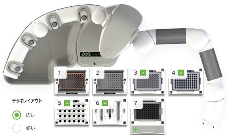
図 3. Andrew+ ピペットおよびドミノブロックを使用した、標準試料およびサンプル調製のための Andrew+ のデッキレイアウト：1.チップ挿入システム（10～300 µL の Optifit チップ）、2.チップ挿入システム（0.1～10 µL の Optifit チップ）、3.マイクロプレート、4.保管プレート、5.マイクロチューブ、6.8 チャンネルピペトリザーバー、7.96-PCR プレート Peltier+。
