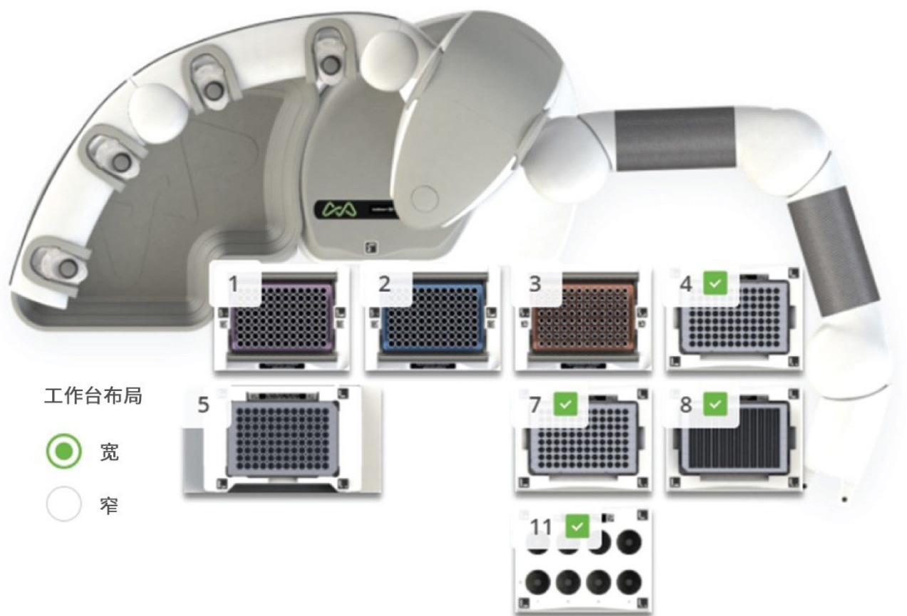
图2.用于实现Oasis 2x4 SPE吸附剂选择方法自动化的Andrew+移液机器人工作台布局和配置，如OneLab中所示
