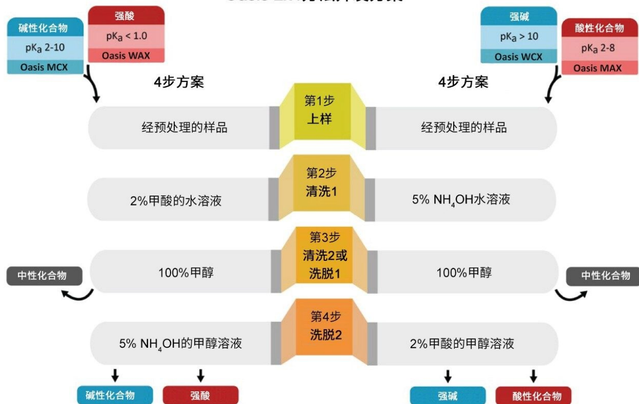
图1.用于方法开发的Oasis 2x4 SPE吸附剂选择方案
