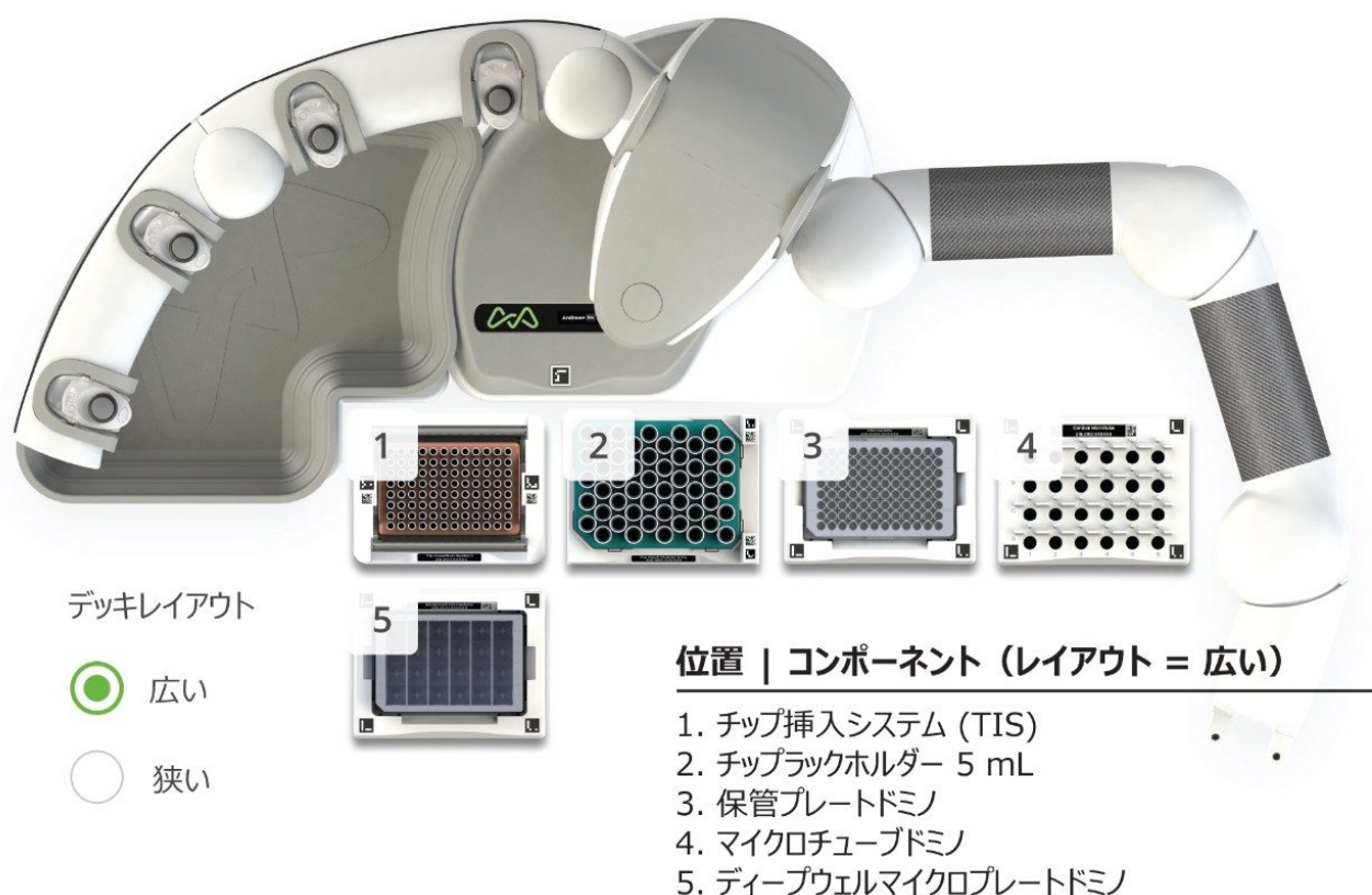
図 1. 連続サンプル希釈および検量線作成用の Andrew+ ピペッティングシステムのデッキレイアウト
