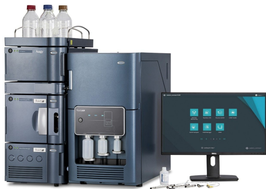
图1. Waters BioAccord LC-MS系统和 waters_connect信息学平台。该系统由ACQUITY UPLC I-Class PLUS结合光学检测器(TUV/FLR)和 ACQUITY RDa质谱检测器组成，并由 waters_connect信息学平台上的UNIFI应用程序进 行控制。该平台上集成了符合法规要求的自动化 数据采集、数据处理、结果审查与报告功能。
