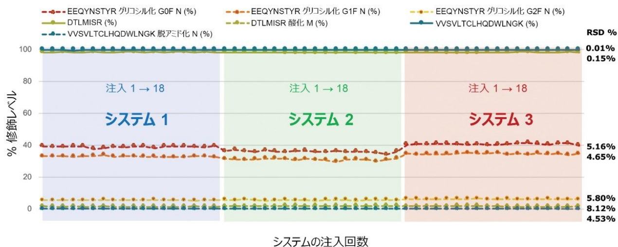
図 2.3 台の BioAccord システムから生成されたデータを使用したペプチド（天然型、修飾型）の相対含有量のプロット。計算の結果、平均 %RSD は 8.12% で、自動分析での LC 保持時間の再現性は十分であり、異なるプラットフォームにわたってペプチド修飾レベルの決定を行うための MS レスポンスが得られることが示されました。
