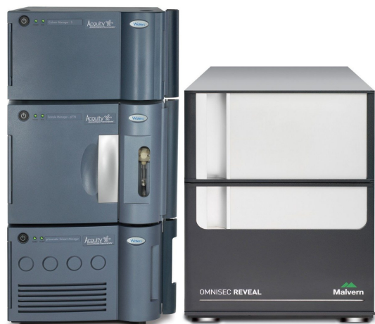
图1.ACQUITY超高效聚合物色谱(APC)系统和马尔文帕纳科OMNISEC-REVEAL
